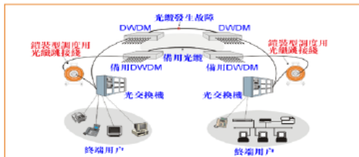
光纜發生故障時施工之臨時接續
